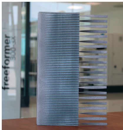
Bild 1. Weniger Lärm von Windkraftanlagen: 3D-gedruckte „Fransen“ an der Rotorblatt-Hinterkante (Tail Edge Serrations) reduzieren die Schallemissionen von Windkraftanlagen deutlich © Röchling
