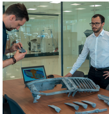
Bild 2. Aktive Luftklappensteuerung: Statt Teile eines Prototyps einzeln zu drucken und dann zu montieren, lassen sich dem Drucker bei geeigneter Anordnung funktional fertige Modelle entnehmen © Röchling
